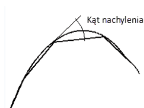
Rysunek 7.12: Kąt wychylenia \alpha pomiędzy dwoma elementami skończonymi
